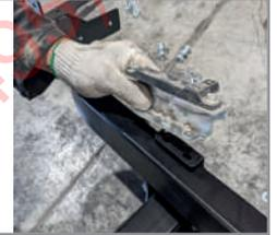
**ШАГ 3.** Установите закладные пластины с двумя гайками в технологические отверстия лонжерона с правой и левой стороны автомобиля. Установите левый и правый кронштейны на место демонтированной штатной балки. На нижние шпильки с обеих сторон установите кронштейны бампера, наживите с обеих сторон кронштейн ТСУ и кронштейн бампера штатными демонтированными гайками. Наживите кронштейны и закладные пластины болтами М12, шайбами 12 гроверными и шайбами 12.
